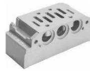
ISO 1 - sottobase sistema universale Manifold uscite dorsali e laterali con scarichi convogliati BF-1071 G1/8 connessioni dorsali e laterali BF-1071S G1/8 impulsi pneumatici laterali BF-1072 G1/4 connessioni dorsali e laterali BF-1072S G1/4 impulsi pneumatici laterali
